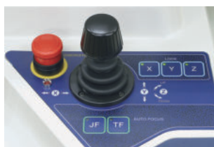
Ovládací panel s joystickem pro rychlé posuvy a tříosé najždění.
