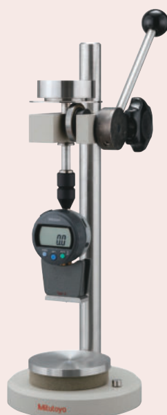
Měřicí stojánek - Velikost stolu: ø 90 mm - Max. výška vzorku: 90 mm
